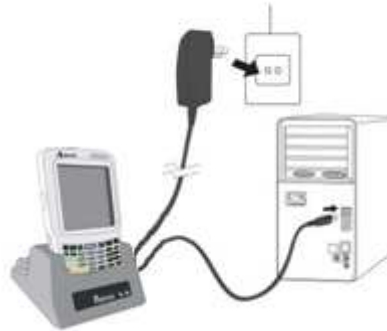
Resim 2-12 İletişim ünitesi ile bağlantı
